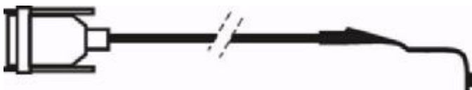
КАБЕЛЬ L1 : Кабель, используемый при настройке, тестировании, а также измерении коэффициента W и константы K при работе с хронографом VEEDER-ROOT 2400.
